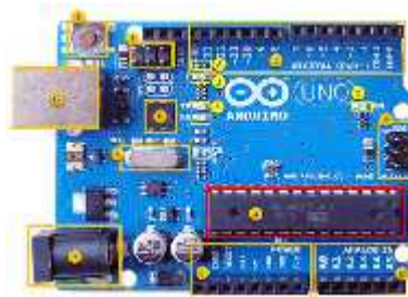
Gambar 5. Modul Arduino Uno R3 ATmega 328
