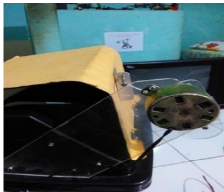
Gambar 7. Pengujian motor DC pada tutup tempat sampah
