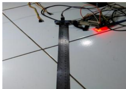
Gambar 3. Pengujian sensor Ultrasonik pada mistar
